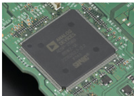
Per IF Sub IF DSP, ogni tipo di segnale processato ADSP-21369 clock @260 MHz
