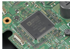
Per modalità banda scope ADSP-21363 clock @333 MHz
