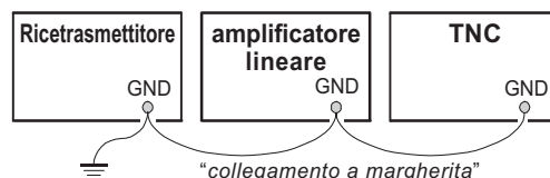
CONNESSIONE DI MASSA IMPROPRIA
